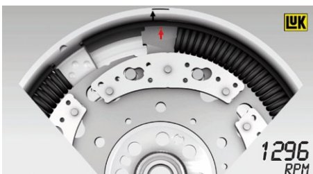
Das Pendelgewicht (sichelförmig) ist in dieser Darstellung im linken Anschlag. Die gegenläufige Bewegung zur zweiten Masse (roter Pfeil) zeigt, dass
